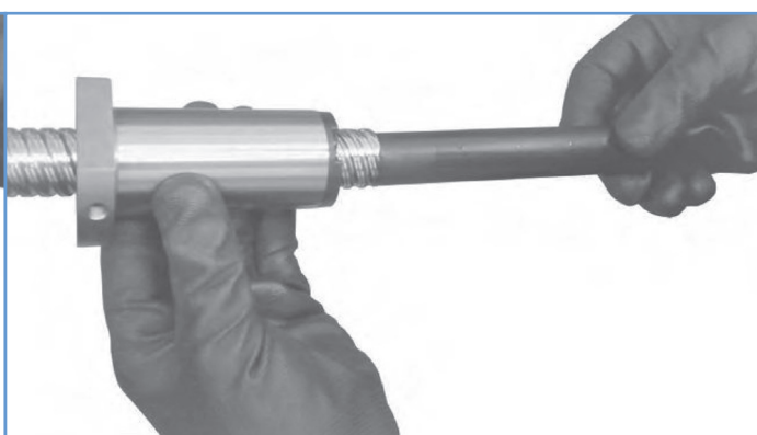
CON LA CHIOCCIOLA INTERAMENTE MONTATA SULLA VITE, TOGLIERE LA FALSA GUIDA
