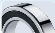
Schermi in gomma nitrilica fissati sull'anello esterno, senza contatto con l'anello interno, che permettono di mantenere la stessa velocità limite di un cuscinetto aperto, lubrificato con grasso.
