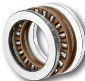
I reggispinta a rullini o a rulli sono progettati per supportare unicamente sforzi assiali in un solo senso. Le superfici di appoggio che servono da pista di rotolamento devono essere rettificate e temperate.
