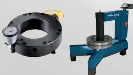
Experts & Tools propone il noleggio di un'ampia gamma di grosse attrezzature per la manutenzione dei Vostri cuscinetti: riscaldamento a induzione, ghiera idrauliche e pompe...
