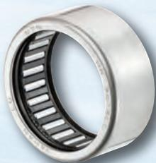
Compatto e leggero, principalmente utilizzato per le applicazioni con poco carico, l'astuccio a rullini è una soluzione di cuscinetto molto economica, poiché l'anello esterno non è lavorato ma ottenuto tramite processo di imbutitura di precisione. Da notare che la geometria della pista di rotolamento è data da quella dell'alloggiamento (poiché lo spessore minimo dell'anello esterno apporta soltanto la durezza e la rugosità necessarie alla pista di rotolamento).
