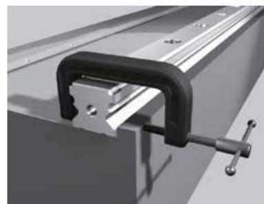
Montaggio guida di riferimento, tramite morsetto: Disporre la rotaia sul piano di montaggio del basamento. Serrare provvisoriamente le viti di fissaggio quindi utilizzare un morsetto per spingere la rotaia contro il riscontro laterale del basamento. Serrare in sequenza le viti di fissaggio applicando la coppia specificata
