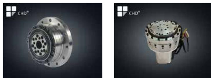
Dimensioni compatte e un peso ridotto ne facilitano l'impiego rispetto a quelle dei riduttori convenzionali che hanno dimensioni e pesi superiori a pari prestazioni. Grazie agli elevati rapporti di coppia, con soli tre componenti base allineati coassialmente : Wave Generator , Flex spline e Circular spline, i riduttori armonici possono essere facilmente adottati su applicazioni già esistenti.
