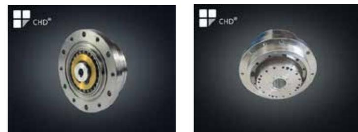
I vantaggi del riduttore armonico rispetto ai riduttori convenzionali si fondano principalmente sulla interazione tra la sua struttura semplice e il principio esclusivo della deformazione elastica di corone dentate in acciaio. I riduttori armonici garantiscono per la loro completa durata di vita una assenza di giuoco assoluta " **Giuoco zero** " e mantengono sull'intera gamma di valori di coppia una elevata rigidità torsionale.
